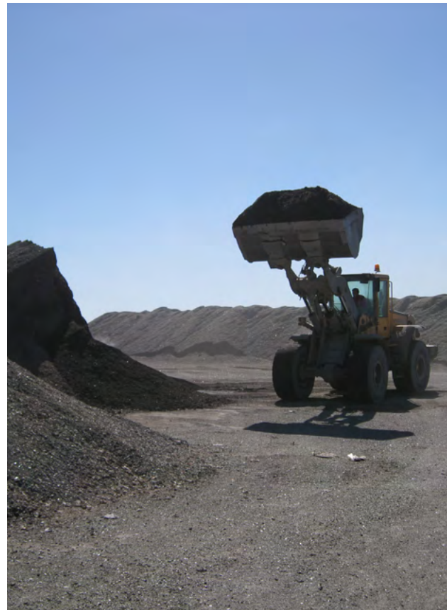
Agregado Artificial proveniente das Escórias de Incineração de Resíduos Urbanos (AEIRU) produzido pela Valorsul (EGF, Portugal).
